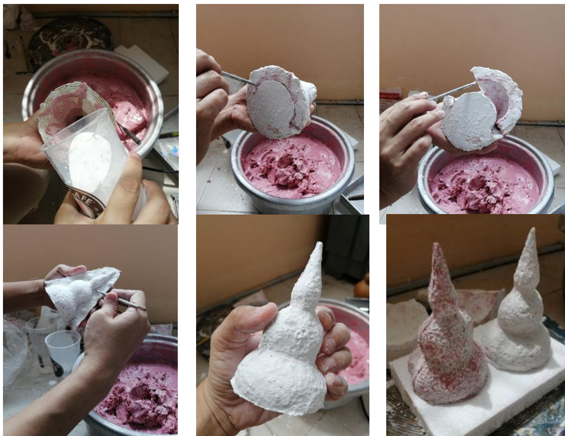
ภาพประกอบ59 : ภาพการหล่อต้นแบบปูนปลาสเตอร์
