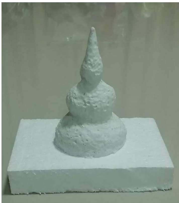
ภาพประกอบ 63 : ต้นแบบที่หล่อจากปูนปลาสเตอร์ ขนาด กว้าง 6.5 CM. x ยาว 7 CM. x สูง 12 CM.
