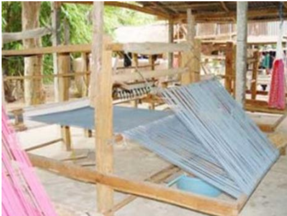
ภาพที่ 3 การขึ้นเส้นด้ายบนเครื่องทอ
